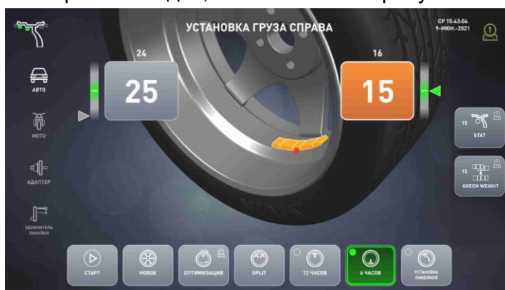
Рисунок 5.8 – Установка в «6 часов» справа
