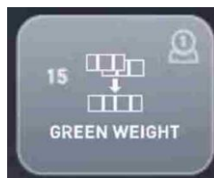
Рисунок 8.2 – Клавиша-индикатор GreenWeight: колесо может быть отбалансировано одним грузом 15 г
