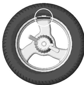
Рисунок 6.6 - Груз установлен в «12 часов»
