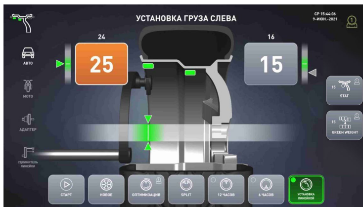
в – установка груза линейкой
