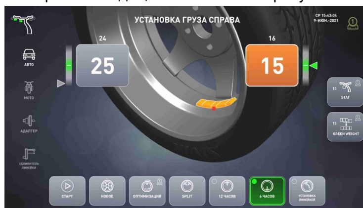
Рисунок 5.8 – Установка в «6 часов» справа
