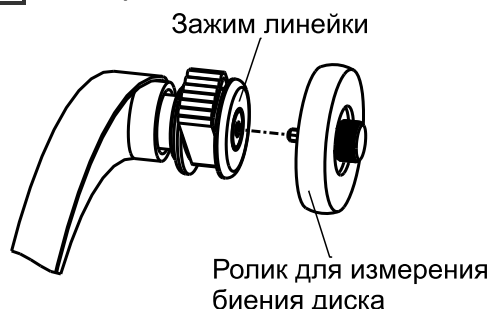
Рисунок 7.7 – Ролик для измерения биений
