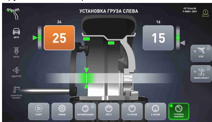
Рисунок 5.10 – Экран при установке груза линейкой
