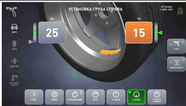
б – установка груза в «6 час»
