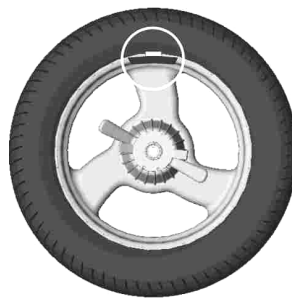
Рисунок 6.5 – Груз установлен в «12 часов»
